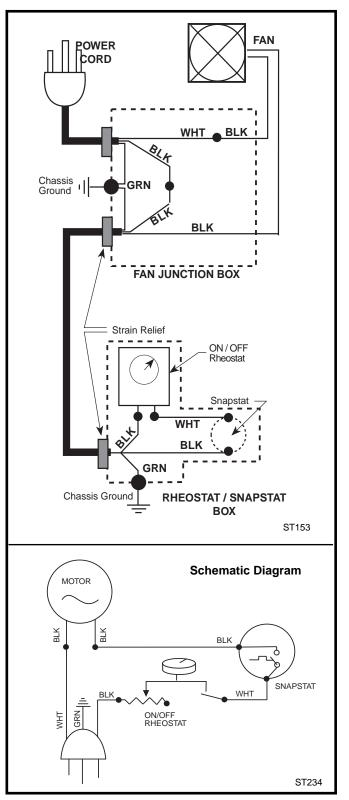
Fig. 71 PDV20/SDVR fan circuit.
